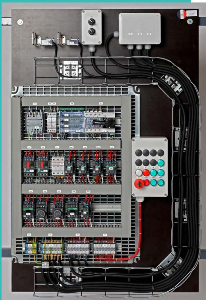
*Chaîne d'alimentation d'un tunnel de retractation.*
