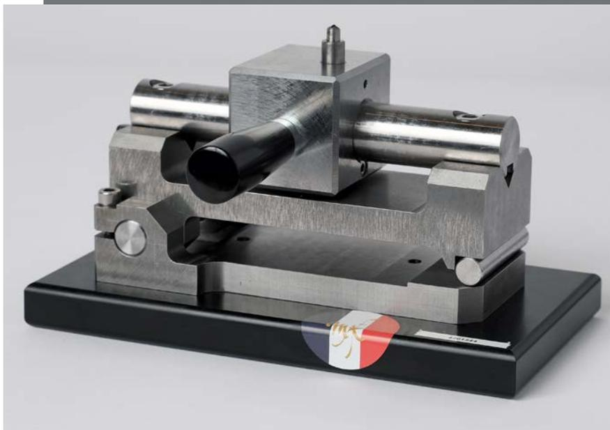
*Appareil sinus pour rectifier des meules coniques.*
