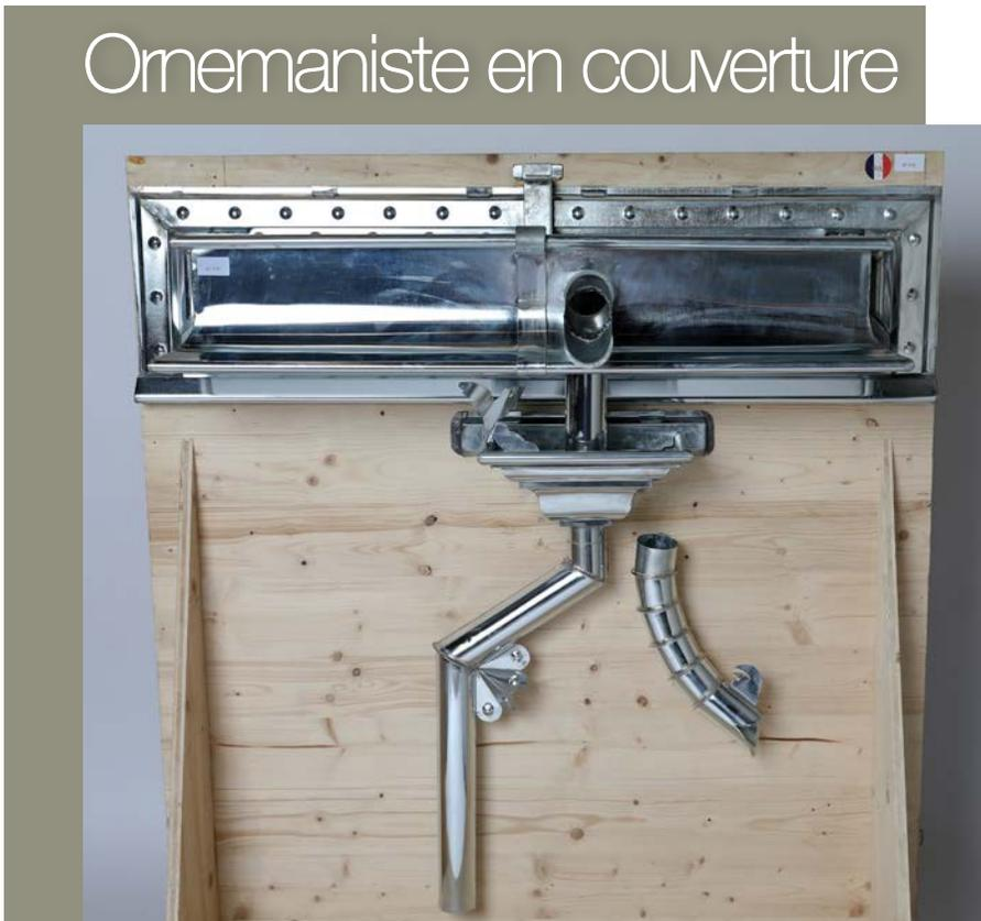
*Réaliser le recueil d'eau pluviale, le devant de socle, la main courante, la cuvette de façade et le tuyau de descente.*
