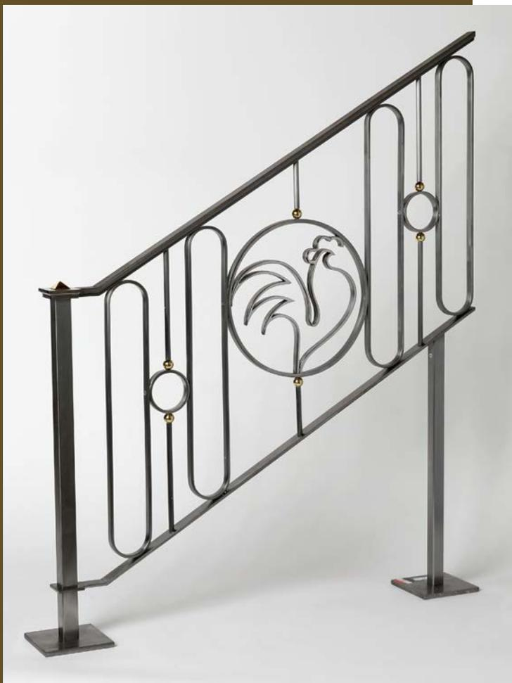
*Réalisation d'un panneau de rampe droit avec un motif central d'un coq stylisé avec des motifs à canaux.*
